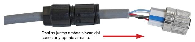
**9.** Para completar el ensamblado, sostenga la pieza negra y la de metal de la carcasa del conector y luego apriete a mano el prensacables a la pieza plástica negra de la carcasa del conector.
