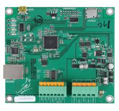
Controlador de celda de carga digital 225DLC
