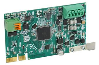
Controlador de celda de carga digital 825DLC
