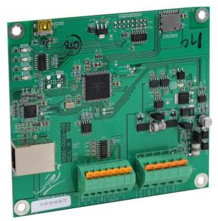
Controlador de celda de carga digital 225DLC
